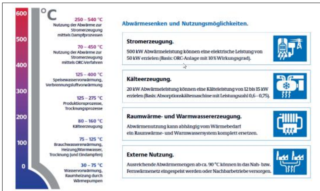
Abbildung 4-8: Nutzung von industrieller und gewerblicher Abwärme in Abhängigkeit vom Temperaturniveau (Quelle: dena)
